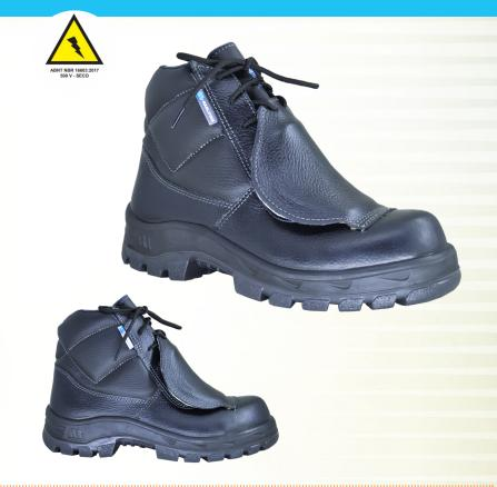
Solado Constituído de duas camadas de poliuretano (PU), injetado diretamente no cabedal, sendo a 1ª camada (entressola) mais macia e leve, com densidade de 0,4g/cm³ proporcionando maior conforto; e 2ª camada (sola) mais compacta com densidade de 1,0 g/cm³, resistente a abrasão com sistema antiderrapante constituído de ranhuras especiais de 3mm de altura e 6mm de largura e resistencia ao escorregamento em piso cerâmico e piso de aço (Nível SRC).
